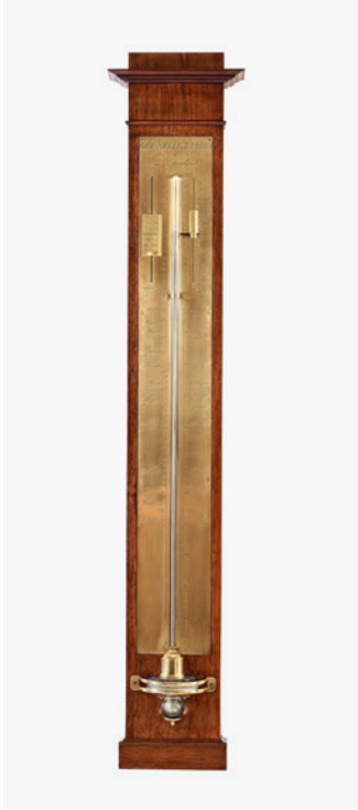
Grasselli y Zambra. Barometer, 1849-1863. Wood, brass, glass, mercury. Inscriptions: At the top: "GRASSELLI Y ZAMBRA / Ópticos de S.. M.. / en Madrid". On the weather scale: «Muy Seco / Sereno Fijo / B. Tiempo / VARIABLE / Lluvioso / Muy Lluvioso / Borrascoso». Rest of inscriptions, from top to bottom: «Pétersbourg / Londres / Venise / Paris / Milan / Toulouse / Laigle / Arras / Zurich / Madrid / Saragosse / Mt Cenis / Mts Pyrénées / Id. Ste Marie / Id. du Jura / Haut Stey / Sommet de la – Rigý / Mont St – Gothard / Mont St – Bernard / Mont – d' Or / Canigou / Pitchincha / Pic du – Ténériffe / Mont – d' Arcus / Zone – México / Ephís – Afrique / Mont – du Pérou / Mont – Cayambé / Chimboraco / Tibet (Asie) / la plus haute cime – de l' himalaya». Colección Banco de España
