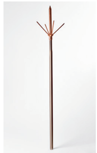
Lightning conductor with multiple rods, c. 1890. Steel, copper and platinum. Patronato de la Alhambra y Generalife. Colección Miguel Giménez Yanguas
